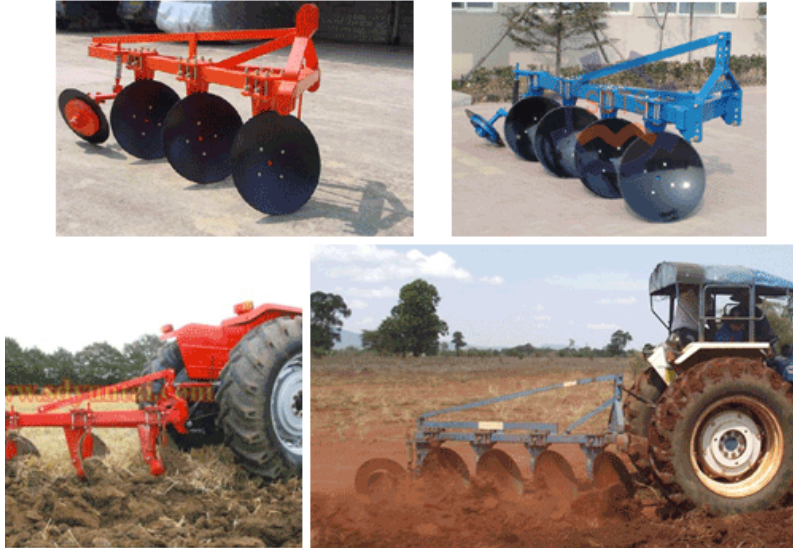
ภาพที่ 3 ชุดไถจาน (ไถบุกเบิก) และการใช้งาน
