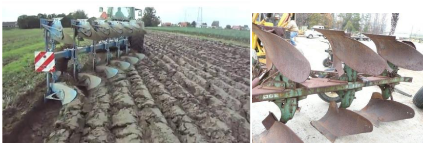
ภาพที่ 5 ชุดไถหัวหมู 2 ทิศทาง และลักษณะการใช้งาน
